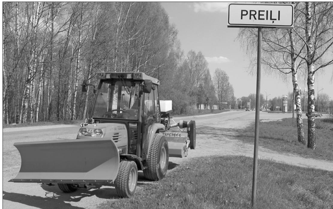
*Maija sākumā SIA «Preiļu saimnieks» saņēma ielu un zālienu sakopšanas kombinēto komunālo traktoru «KUBOTA STV32» ar papildaprikojumu. Šī traktora jauda ir 32 ZS. Papildaprikojumā ietilpst ielu, ietvju uzkopšanas mašīna un arī zāles mulcešanas agregāts. Šis traktors būs ļoti noderīgs labiekārtošanas-apzālumošanas darbiem (parka un tam piegulošās teritorijas sakopšanai, kā arī ietvju tīrišanai). Traktors kopā ar papildus aprīkojumu izmaksāja 27 474 Ls.*
